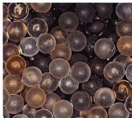
Fig. 6 - Sferette di vetro cromatizzato contenute nel tray di sterilizzazione.
